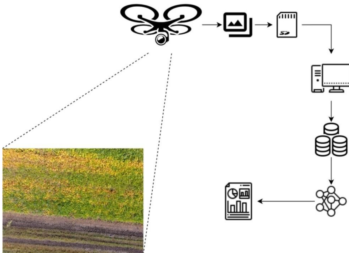
Рисунок 1 – Схематическое представление процесса выполнения аэрофотосъёмки и обработки полученных данных
