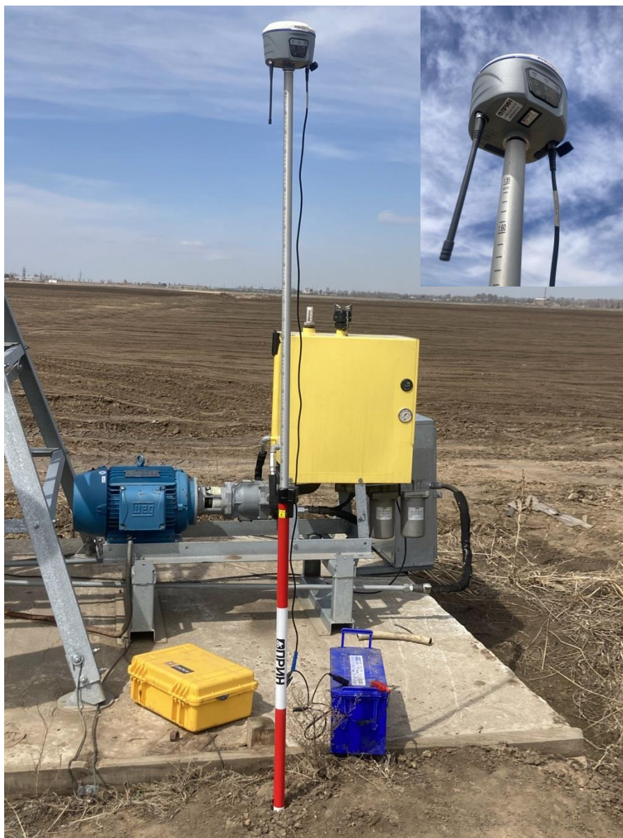
Рисунок 2 – Общий вид центральной поворотной башни дождевальной машины T-L Irrigation company и геодезического приемника PrinCe i50
