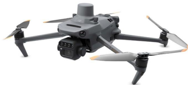
Рисунок 1 – Квадрокоптер DJI Mavic 3M Multispectral [8]
