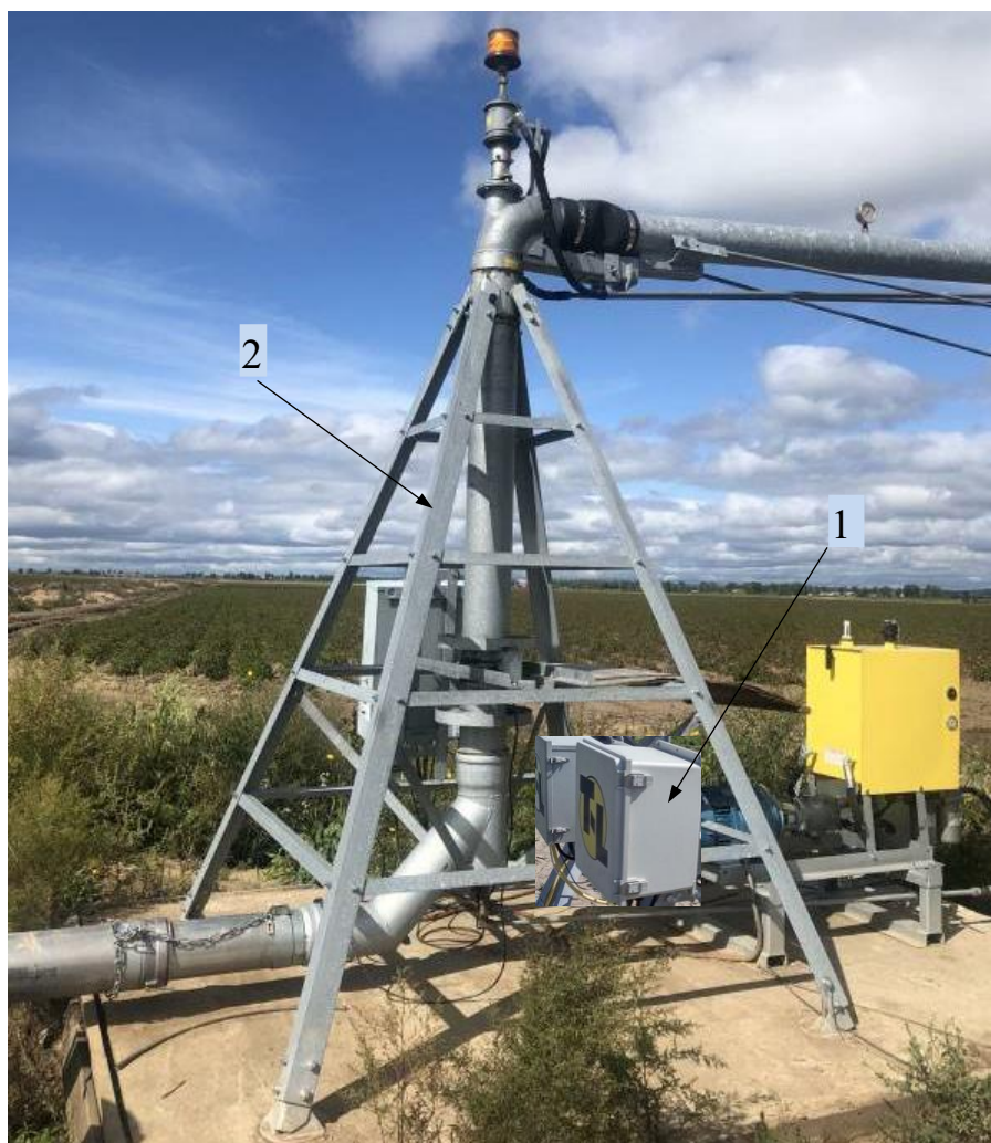
Рисунок 1 – Центральная поворотная башня с основным трубопроводом, гидравлическим приводом, расширительным баком и удаленным терминалом
